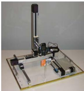
**Abbildung 1.** Mechanischer Aufbau des Testroboters. Durch die Verwendung von Plexiglasabstandhalter wird eine Beeinflussung des Feldes durch metallische Komponenten vermieden.
